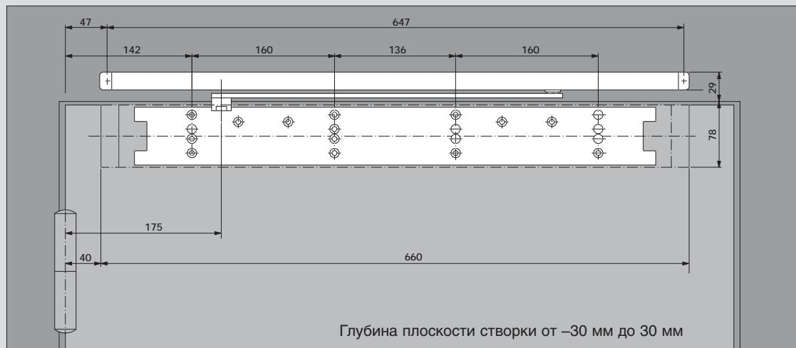
Глубина плоскости створки от -30 мм до 30 мм
